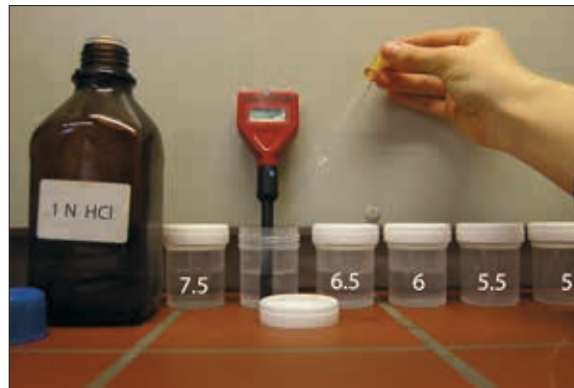
Abb. 126 Herstellen der Testpufferlösung
