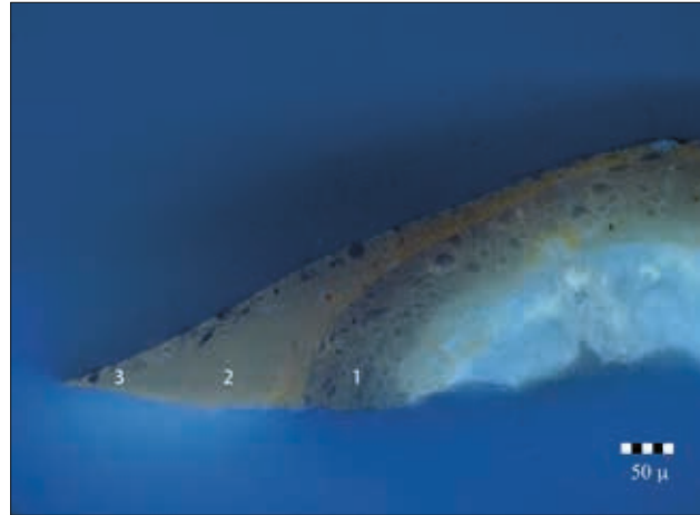
Abb. 95 Querschliff R10a im UV, 20-fache Vergrößerung
