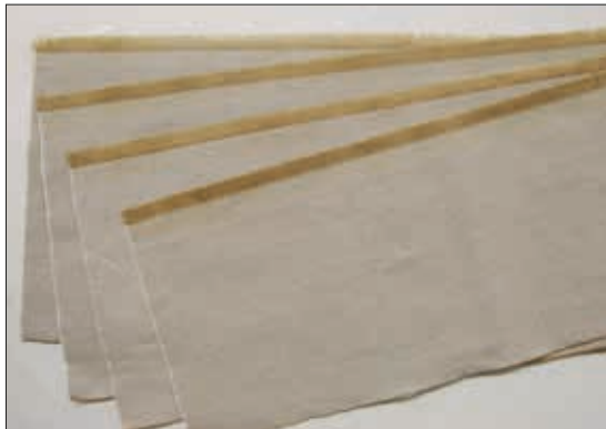
Abb. 140 vorbereitete Spannstreifen aus Polyestergewebe
