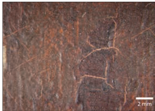
Abb. 76 Säule, Vordergrund: Frühschwundrisse bis auf die lachsfarbene Unterma- lung
