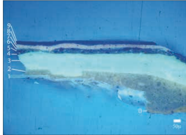
Abb. 86 Querschliff MS2 im UV, 10-fache Vergrößerung
