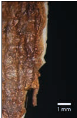
Abb. 54 Riss a/c, mittig, Bereich der großen Säule: Seitenansicht der Bruchkante
