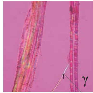
Abb. 106 Polarisationsmikroskopie an Faserprobe F1: Orange I in N-S-Richtung
